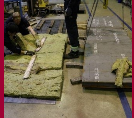
3. Đậy lại bằng tấm cách nhiệt
