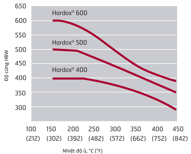
Hình 11: Độ cứng bề mặt so với nhiệt độ ủ.
