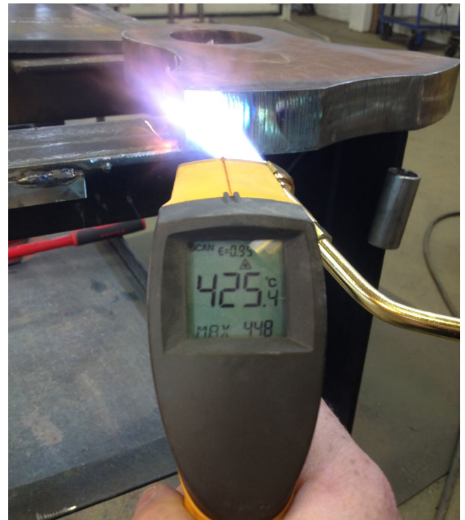
Hình 10: Đo nhiệt độ trong quá trình gia nhiệt sau.
