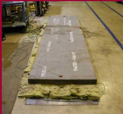
5. Đặt tấm thép lên và đặt các cặp nhiệt để ghi lại nhiệt độ theo thời gian
